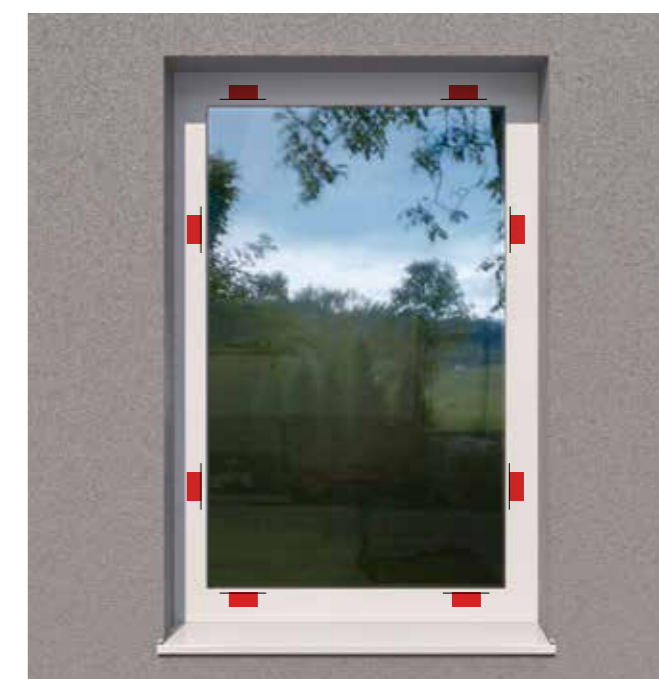
Disposizione standard dei punti di chiusura I-tec Secure
